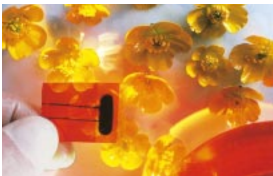
TRANSISTOR TOUT ORGANIQUE À BASE DU DIMÈRE (SEXITHIOPHÈNE) D'UNE MOLÉCULE SIMPLE QUE L'ON TROUVE À L'ÉTAT NATUREL DANS LE BOUTON D'OR. © CNRS, LMM - A. Muriot
